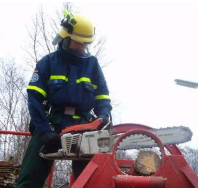
Sascha Henkel bei einer Kettensägeausbildung. Der Baumstamm wird in dem roten Gestell in Spannung versetzt - es ist beim Sägen also Vorsicht geboten. Wie auch in der Realität.
