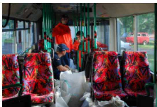
2.9.: Wir stapeln Sandsäcke in einen O-Bus der Barnimer Busgesellschaft. Diese wollte Testfahrten mit einer simulierten Belastung absolvieren.
