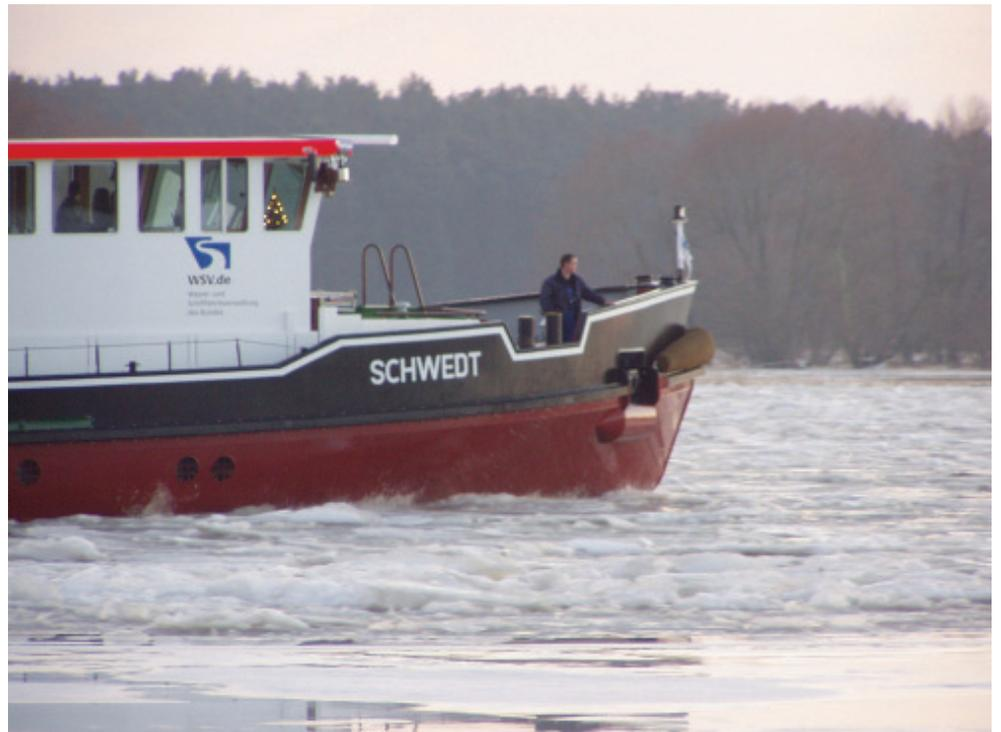
Einer der Eisbrecher, die schließlich das Eis auf der Oder brachen und damit einen Abfluss desselben ermöglichten.
