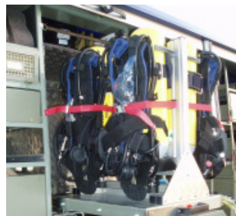
Vier komplette Atemschutzgeräteausrüstungen können auf dem „GKW III“ verlastet werden
