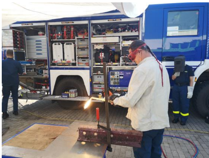
Ausbildung in der Bergung mit dem neuen Schneidbrenner. Hier der Helfer Daniel Kowatzki. (Foto: Mirko Wolter)
