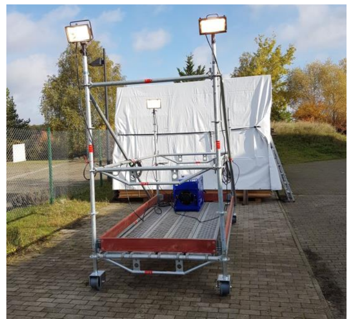
Gleiswagen, der aus dem Bausatz Bahn des EGS gebaut werden kann (Foto: Leonard Winter)
