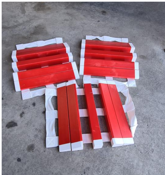
Die neuen Schlauchbrücken, die sowohl für die Bergung als auch für die Fachgruppe N beschafft werden konnten. (Foto: Leonard Winter)
