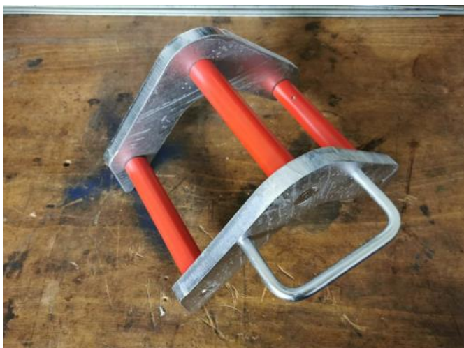
Kleine Dinge große Wirkung. Ein sogenannter Kantenreiter sorgt dafür, dass Seile oder Gurte, die über Kanten geführt werden nicht beschädigt werden. (Foto: Christian Richter)
